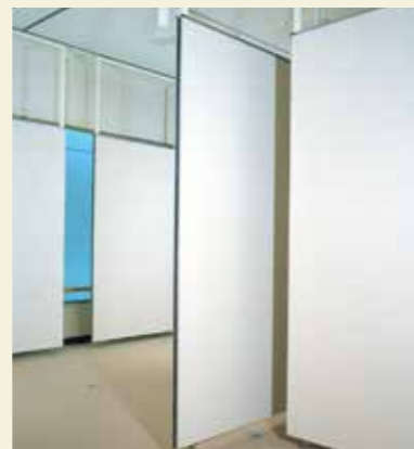
▲ 絵画ラック ハンガーレールはアールタイプ R-60 程度を用い、本体は角パイプ、金網、平板を組み合わせて作ります。床にはガイドレールをつけてあります。
