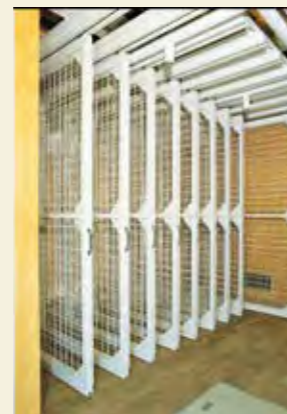
▲ 絵画ラック ハンガーレールはアールタイプ R-60 程度を用い、本体は角パイプ、金網、平板を組み合わせて作ります。床にはガイドレールをつけてあります。
